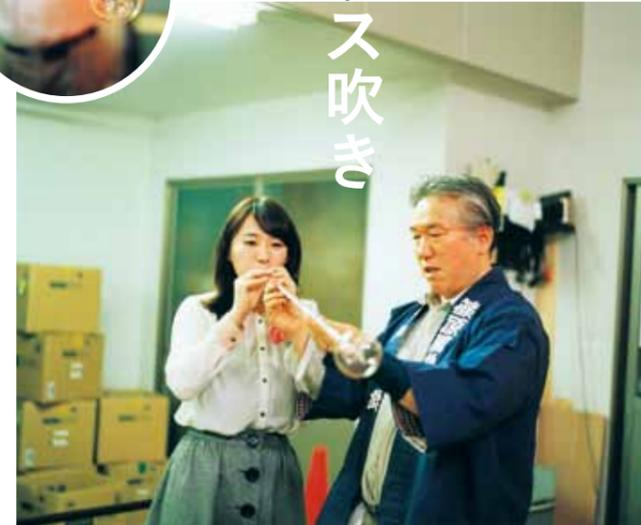
吹く時に上を向けば下にガラスが垂れ、下を向けば上にガラスが垂れる。その原理を利用しながら、ガラスの厚みを調節。基本的に口玉を作る時は下を向き、本体を吹くときは上を向く。音が鳴る部分を厚くするためだ。
