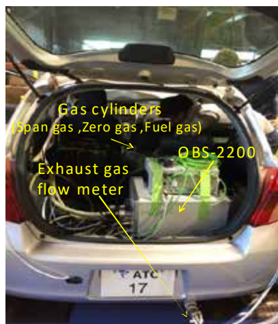
完成車を用いた有害排出ガス計測
