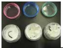
遮へい率を変えて試作された放射線防護クリーム
