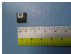
小型検出器（光刺激蛍光検出器）：画質に影響せずに設置可能。
