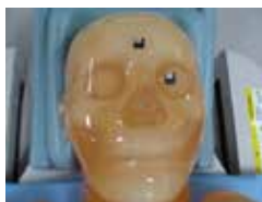
ファントム表面に小型検出器を設置し、線量測定を行う。
