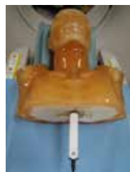
電離箱線量計をファントムに挿入した状態
