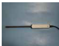
CT用電離箱線量計：長さ10 cmのためスキャンボリュームに対応している。
