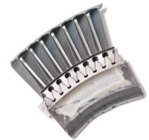
エンジンの部品のひとつであるブレード。部品はどれも高温になるため、材料の開発も重要になる。
