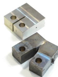
亀裂が入った金属材料。
