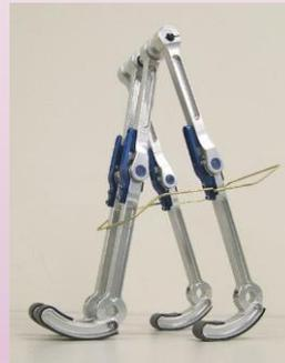
私たちは何気なく足を出して2足歩行をしています。ロボットの歩き方はカクカクしているイメージがしますよね。スムーズな足の動きは、ロボットで動かすとともに大変で「歩くこと」が複雑な仕組みであることを教えてください。受動歩行ロボットは、電気などのエネルギーを使わず、重力のみによって緩やかな
