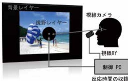
図1：視線同期型制限視野移動システム
