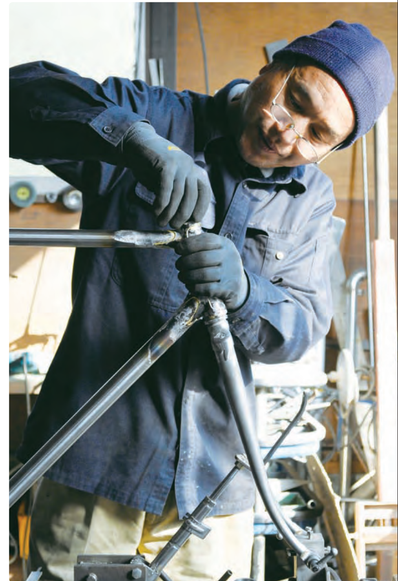
クロモリという合金素材のパイプとラグと呼ばれるパーツをつなぎ合わせ、フレームを組んでいく。
