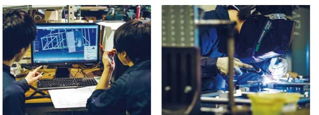
活動拠点は、理工学部が誇る実習工場。シャシ班、パワトレ班、電装班、ボディ班に分かれて開発を進める学生たち。設計では最新の3DCADシステムを使いこなし、フレーム溶接をはじめとした全工程の作業を自ら手掛けている。
